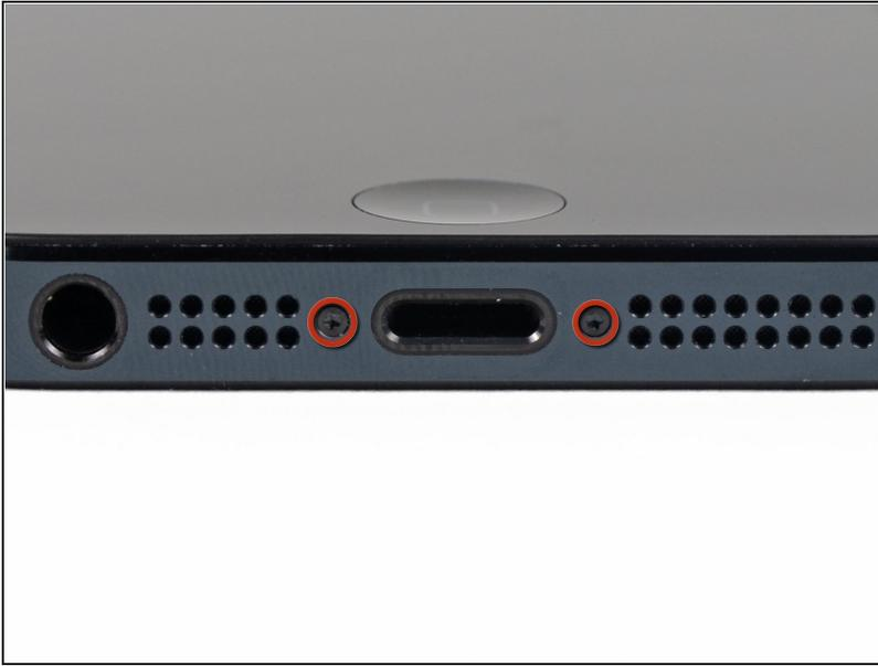
**⚠** Antes de continuar, descarga la batería del iPhone por debajo del 25%. Una batería de litio-ion cargada puede incendiarse y / o explotar si se perfora accidentalmente.
