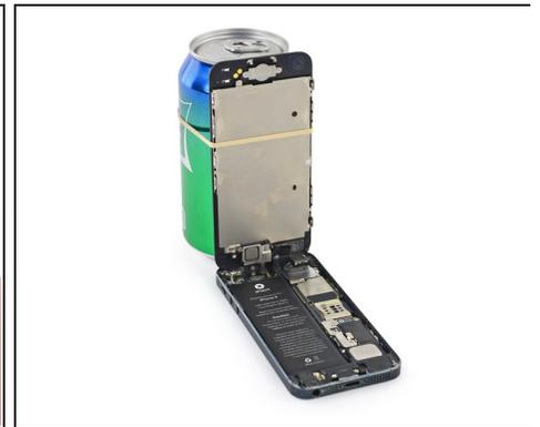
**⚠ No intentes remover completamente el ensamblaje del panel frontal de la caja trasera, aún hay varios cables conectados en la parte superior del iPhone.**
