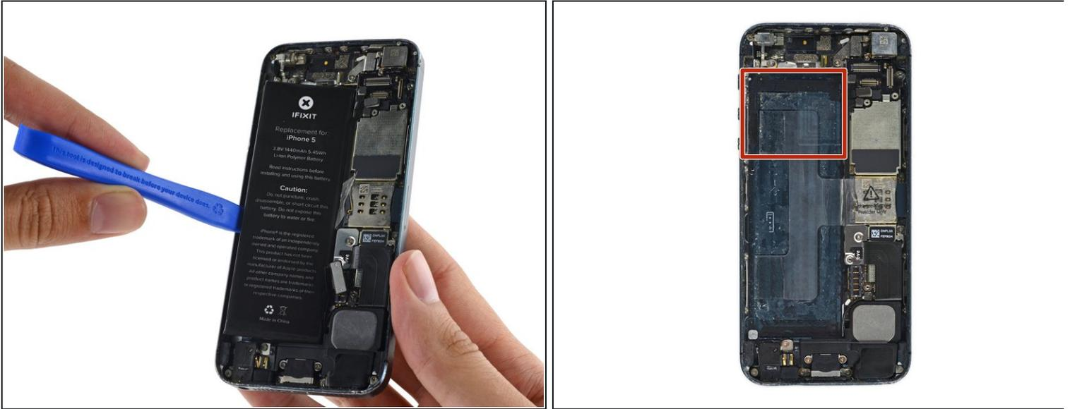
**⚠ Cuidadosamente** utiliza la herramienta de apertura de plástico para levantar la batería con palanca, **solo en el borde exterior del teléfono**. Si intentas de levantar con palanca en cualquier otro lugar, especialmente cerca de la placa lógica, **puede resultar en daño a la placa lógica**.
