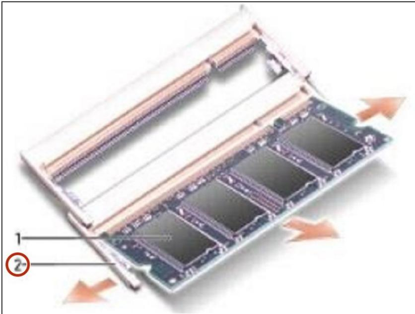
**i** AVISO: para evitar daños en el conector del módulo de memoria, no utilice herramientas para extender los clips de fijación del módulo de memoria.
