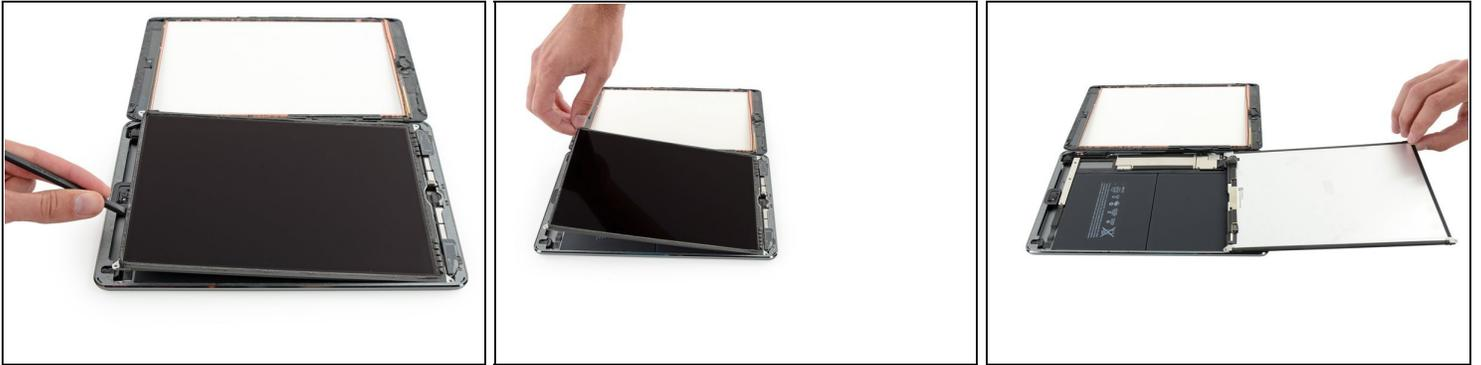
**⚠ No intentes remover completamente el LCD del iPad, este sigue conectado por varios cables en la parte del botón inicio. levanta solamente de la cámara frontal.**
