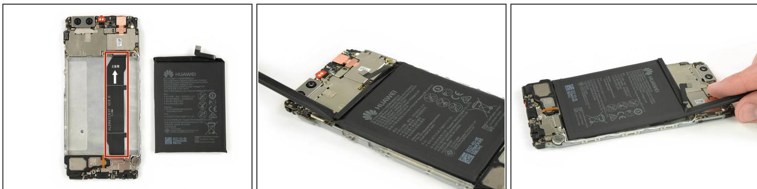
**⚠** En los siguientes pasos, es importante evitar doblar o perforar la batería, ya que los daños pueden provocar un incendio de la batería.
