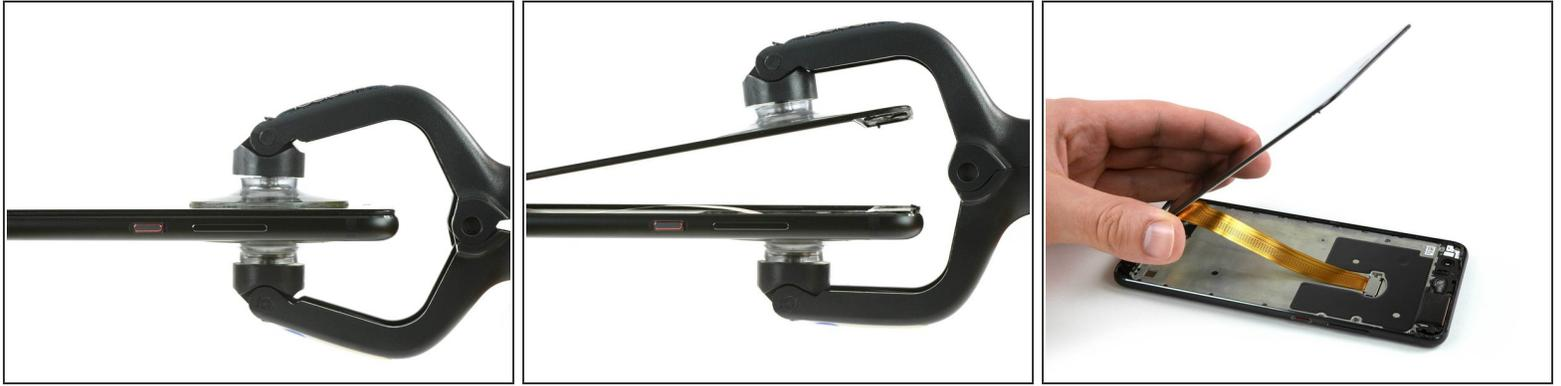
**⚠ Hay un cable de pantalla delgado entre la pantalla y el teléfono, ten mucho cuidado de no romperlo al abrir el dispositivo**
