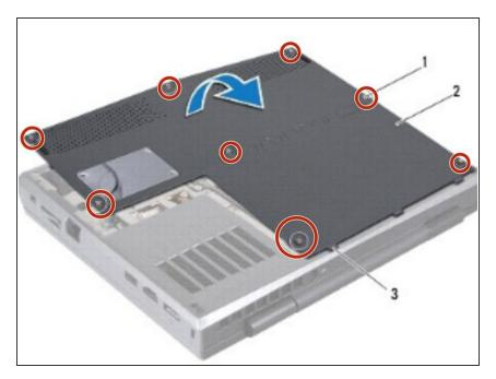
Apriete los ocho tornillos que aseguran la cubierta de la base a la base de la computadora.
