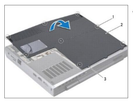
Levante la cubierta de la base de la computadora.
