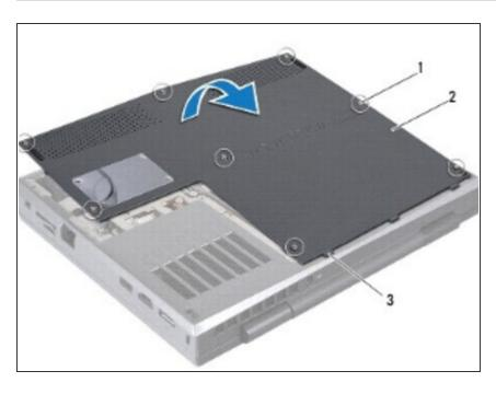
Alinee las lengüeta de la NUEVA cubierta de la base con las ranuras de la base del equipo y coloque la cubierta de la base en su posición.
