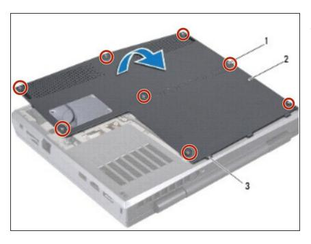
Afloje los ocho tornillos que aseguran la cubierta de la base a la base de la computadora.
