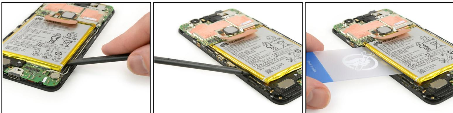
**⚠ Advertencia:** no introduzcas el spudger o tarjeta de plástico muy profundamente por debajo de la batería. El cable de pantalla se encuentra por debajo de la batería.
